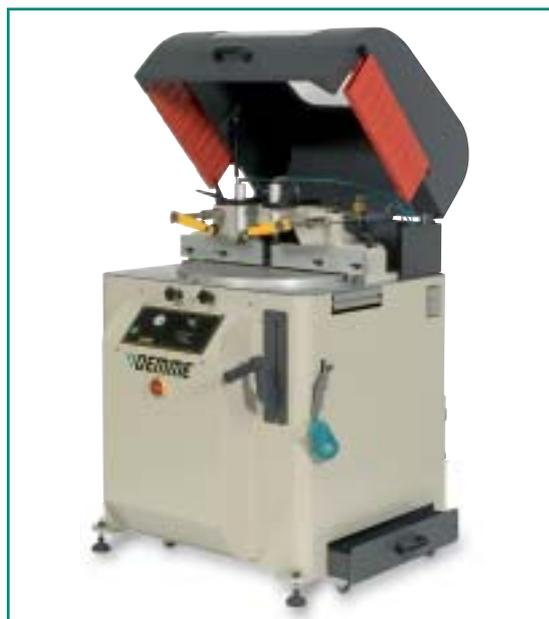
Sistema automatico di rotazione dei pressori orizzontali allo sbloccaggio atto ad agevolare le operazioni di carico e scarico del profilato in lavorazione
