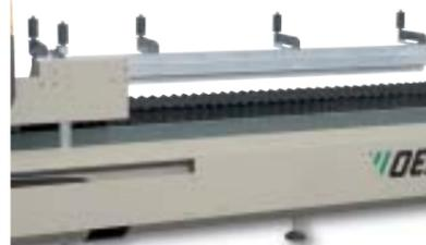
La partie frontale est dotée d'une ample goulotte pour les copeaux et les guides sont protégées par un soufflet
