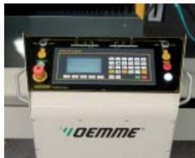
L'unité de contrôle mobile est facilement positionnable grâce à l'utilisation de guides et chaînes porte-câbles
