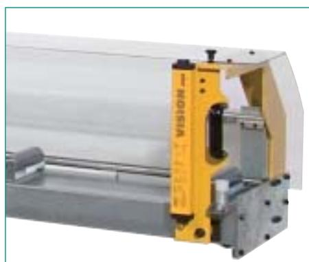
**Système de sécurité avec photocellules**
